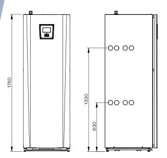
Die Rohrinstallation kann an der rechten oder linken Seite sowie an der Ober- oder Rückseite der Wärmepumpe erfolgen.
