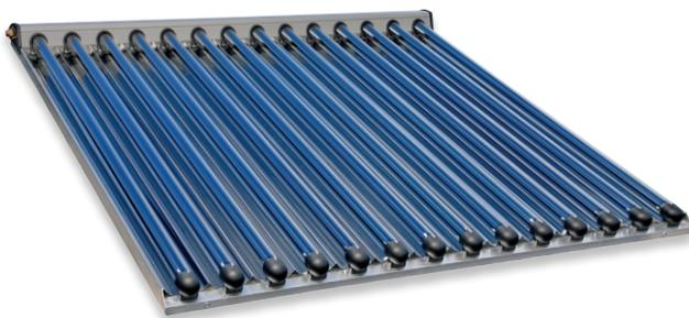
CTCs Vakuumröhrenkollektoren können an Wänden und auf Dächern montiert werden. Sie arbeiten effektiver bei geringer Sonneneinstrahlung im Frühjahr und Herbst (1240 kWh pro Solarkollektor und Jahr). Sie bestehen aus Glasröhren, in denen ein Vakuum herrscht, das als Isolierung dient. Diese Technologie sorgt für eine maximale Leistung.
