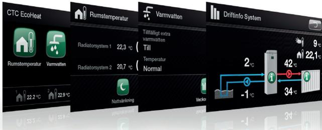
CTC EcoHeat verfügt über ein Touchscreen. Dieses ist nicht nur großzügig bemessen (4,3 Zoll), sondern auch in Farbe. Es unterstützt mehrere Sprachen und arbeitet mit leicht verständlichen Symbolen. Sie können ganz einfach Wärme, Brauchwasser usw. einstellen sowie umfassende Informationen zum Betrieb abrufen.
